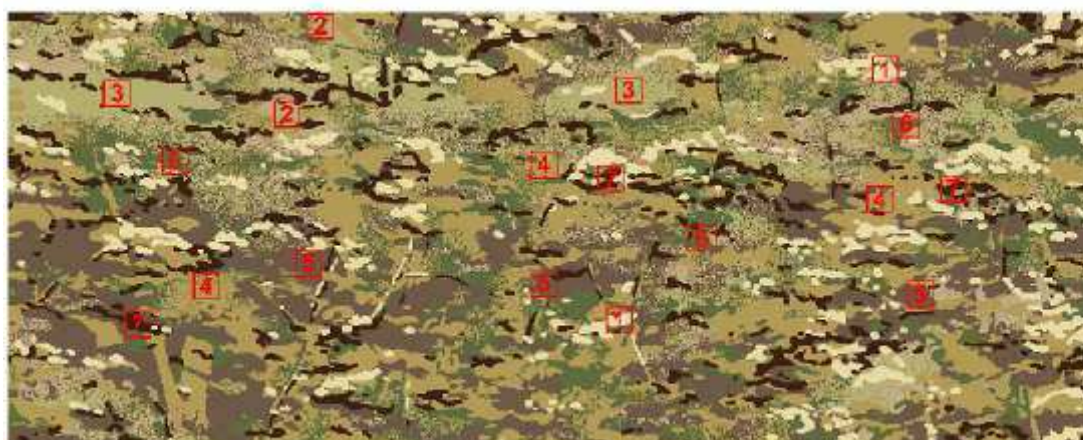
Miejsca pomiaru zgodności barwy z wzorcem dla poszczególnych kolorów
